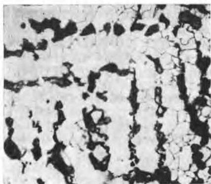
Рис. 251. Микроструктура доэвтектоидной литой стали, подвергнутой отжигу: зерна феррита (светлые), сетка перлита (темная). \times 200
