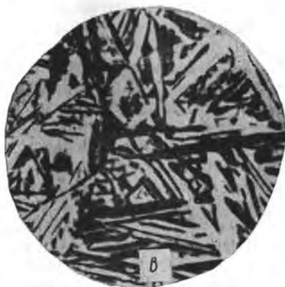
Рис. 153. Диаграмма равновесия Ag—Al (а), микроструктура сплава Ag+22% (ат.) Al после массивного (б) и мартенситного (в) превращений. \times 200
