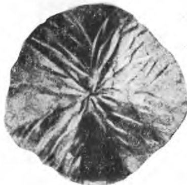
Рис. 209. Одиночный сферолит шаровидного графита
