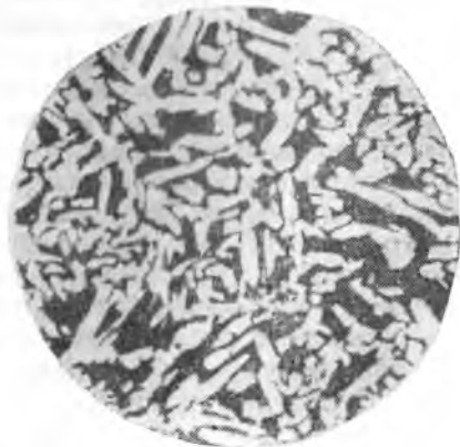
Рис. 291. Микроструктура \alpha + \beta -латуни с 41 % Zn: \alpha -фаза (светлая) и \beta -фаза (темная). \times 100
