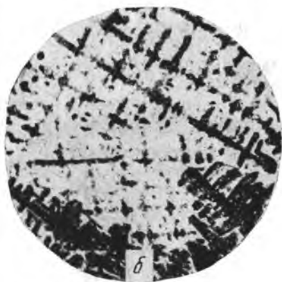
Рис. 35. Дендрит Д. К. Чернова, найденный в усадочной раковине 100-т слитка. Длина кристалла около 40 см (а). Дендритное строение затвердевшего сплава меди с никелем (б). \times 100
