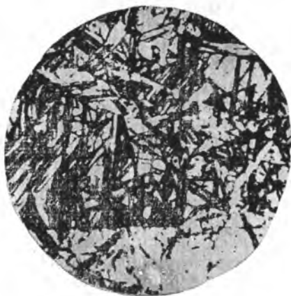
Рис. 85. Микроструктура титана, охлажденного с высокой температуры. Пластины \alpha -титана на светлом фоне \beta -титана. \times 200
