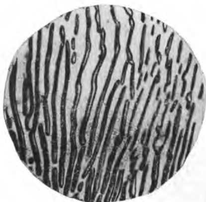
Рис. 152. Эвтектоид в системе Fe—C. Видны пластины фаз \alpha (светлая) и \text{Fe}_3\text{C} , образовавшихся при эвтектоидной реакции. \times 400
