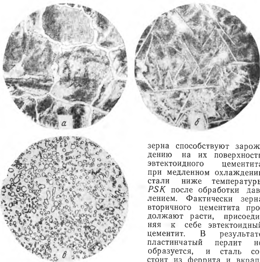
Рис. 220. Микроструктура заэвтектоидной стали: a — перлит и вторичный цементит в виде сетки. \times 200 б — перлит и цементит игольчатый. \times 200 ; в — феррит и зернистый цементит. \times 600
