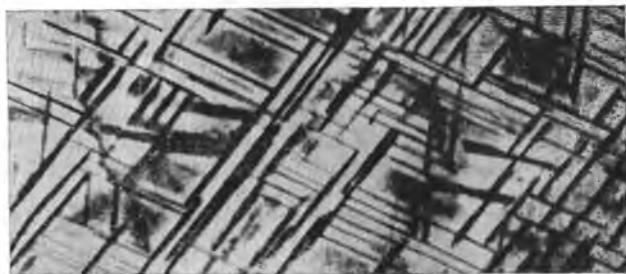
Рис. 143. Выделение второй фазы внутри зерна в результате длительной выдержки при 160^\circ\text{C} после резкого охлаждения с 525^\circ\text{C} . Сплав \text{Al}+4,4\% \text{Ag} (см. диаграмму на рис. 153, а)
