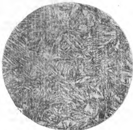
Рис. 230. Мартенсит в стали с 0,45 % С. \times 400
