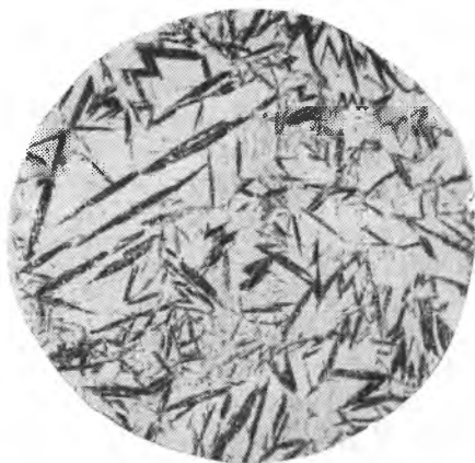
Рис. 232. Крупные иглы мартенсита в стали с 1,3 % С и 1,85 % Мп. Виден непретравившийся аустенит (светлый). \times 400
