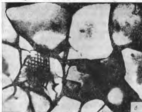
Рис. 5. Блочная структура кристалла: a — схема; б — реальная блочная структура в алюминии, наблюдаемая в электронном микроскопе на просвет. \times 35000
