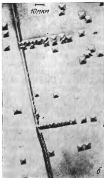
Рис. 59. Скопление дислокаций у препятствия: а — схема; б — скопление дислокаций у границы зерна
