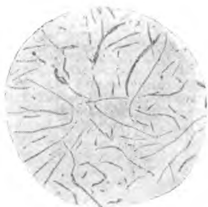
Рис. 207. Микроструктура серого чугуна. Видны графитовые включения, структура металлической основы не выявлена. \times 100
