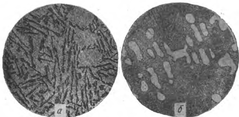
Рис. 302. Микроструктура литого силумина АЛ2 с 13 % Si. \times 200 : a — немодифицированного: алюминия и игольчатые кристаллы кремния; б — модифицированного: дендриты алюминия (светлые) и эвтектика Al+Si (темная)
