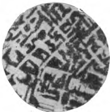
Рис. 289. Микроструктура литой \alpha -латуни (видна дендритная ликвация). \times 190
