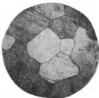
Рис. 268. Микроструктура закаленной стали с 1,3 % С и 13 % Мп: полиэдрические зерна аустенита; линии появились при изготовлении шлифа. \times 200
