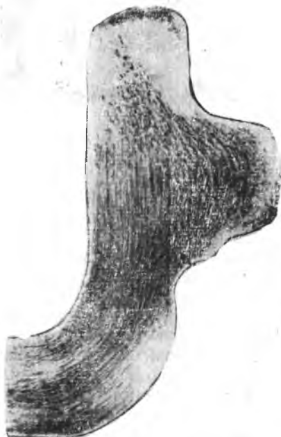
Рис. 253. Волокнистая макроструктура в продольном сечении горячедеформированной заготовки. \times 3,5
