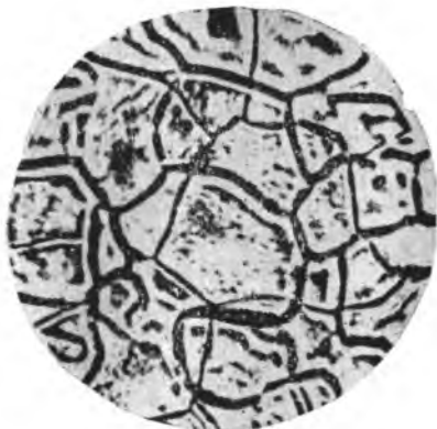
Рис. 78. Совмещение границ зерен \gamma\text{-Fe} (жирные линии) и \alpha\text{-Fe} (тонкие линии). Границы зерен \gamma\text{-Fe} выявлены травлением при 930^\circ\text{C} , \alpha\text{-Fe} — при 20^\circ\text{C} . \times 200
