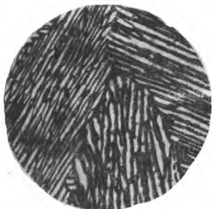
Рис. 316. Продукты ориентированного распада \beta \rightarrow \alpha + \beta при охлаждении с 1000 °С сплава ВТ6. \times 500 (Б. А. Колачев)
