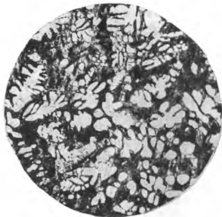
Рис. 321. Микроструктура литого сплава 96 % Zn, 4 % Al: дендриты \beta -фазы (светлые), частично распавшаяся \alpha_2 -фаза (темный фон). \times 100 (М. В. Мальцев, Т. А. Барсукова, Ф. А. Борин)
