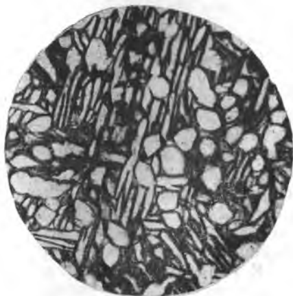
Рис. 315. Структура сплава VT6 после термообработки: округлые включения \alpha -фазы, образовавшиеся при 900 °С, и продукты ориентированного распада \beta -фазы на \alpha + \beta при охлаждении. \times 500 (Б. А. Колачев)
