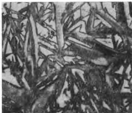
Рис. 238. Последовательное развитие игл мартенсита в пределах одного аустенитного зерна. \times 1650
