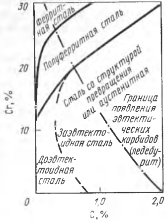
Рис. 273. Проекция поверхностей фазовых превращений в твердом состоянии в системе Fe—Cr—C
