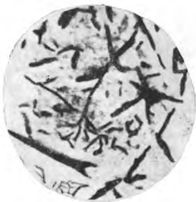
Рис. 208. Первичный и эвтектический графит в заэвтектическом чугуне; структура металлической основы не выявлена. \times 200
