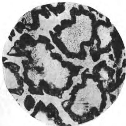
Рис. 294. Микроструктура литой бронзы с 16 % Sn: зерна \alpha -фазы и эвтектоид \alpha+ по их границам. \times 400
