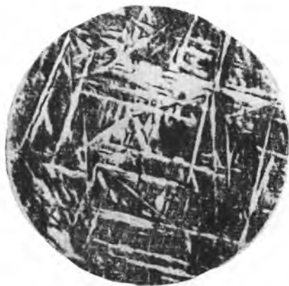
Рис. 298. Микроструктура закаленной бронзы с 10 % Al: имеется метастабильная мартенситная \beta' -фаза. \times 200
