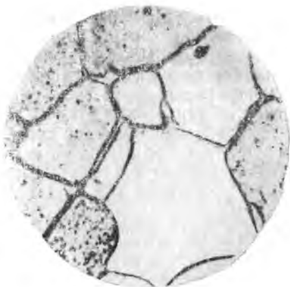
Рис. 215. Микроструктура технического железа, содержащего малое количество углерода: феррит и третичный цементит по границам зерен. \times 400
