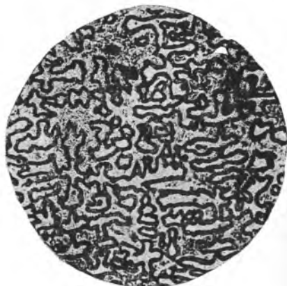
Рис. 293. Микроструктура литой бронзы с 10 % Sn: \alpha -фаза (светлая) и эвтектоид \alpha+\delta (пестрый). \times 200
