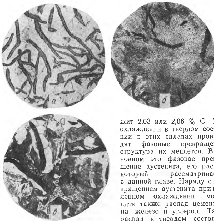
Рис. 221. Микроструктура серого чугуна: графит и металлическая основа со структурой феррита (а), перлита (б), перлита и феррита (в). \times 100
