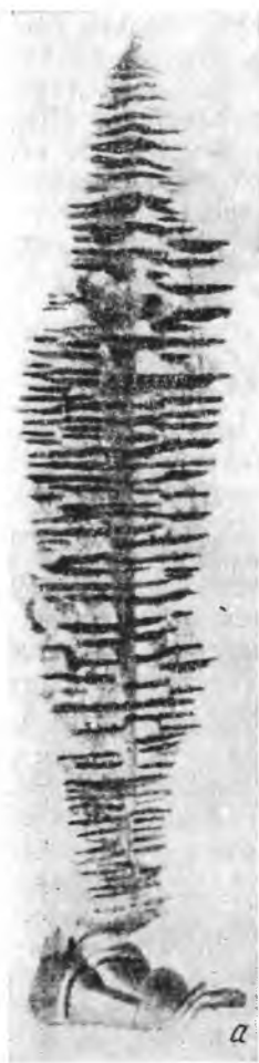
Рис. 35. Дендрит Д. К. Чернова, найденный в усадочной раковине 100-т слитка. Длина кристалла около 40 см (а). Дендритное строение затвердевшего сплава меди с никелем (б). \times 100
