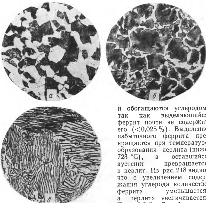
Рис. 218. Микроструктура углеродистой стали: а — 0,30 % С, феррит и перлит. \times 200 ; б — 0,70 % С, перлит с сеткой феррита. \times 200 ; в — перлит, 0,8 % С. \times 500
